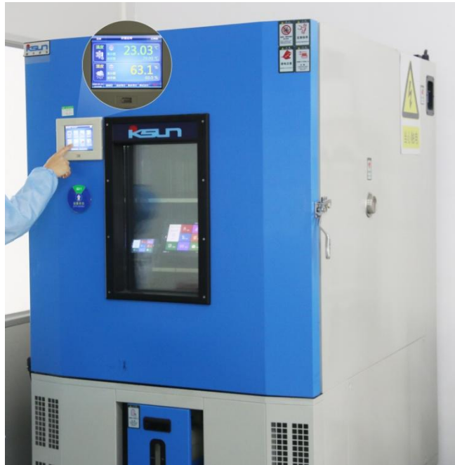
图 5-7 高低温老化测试图
